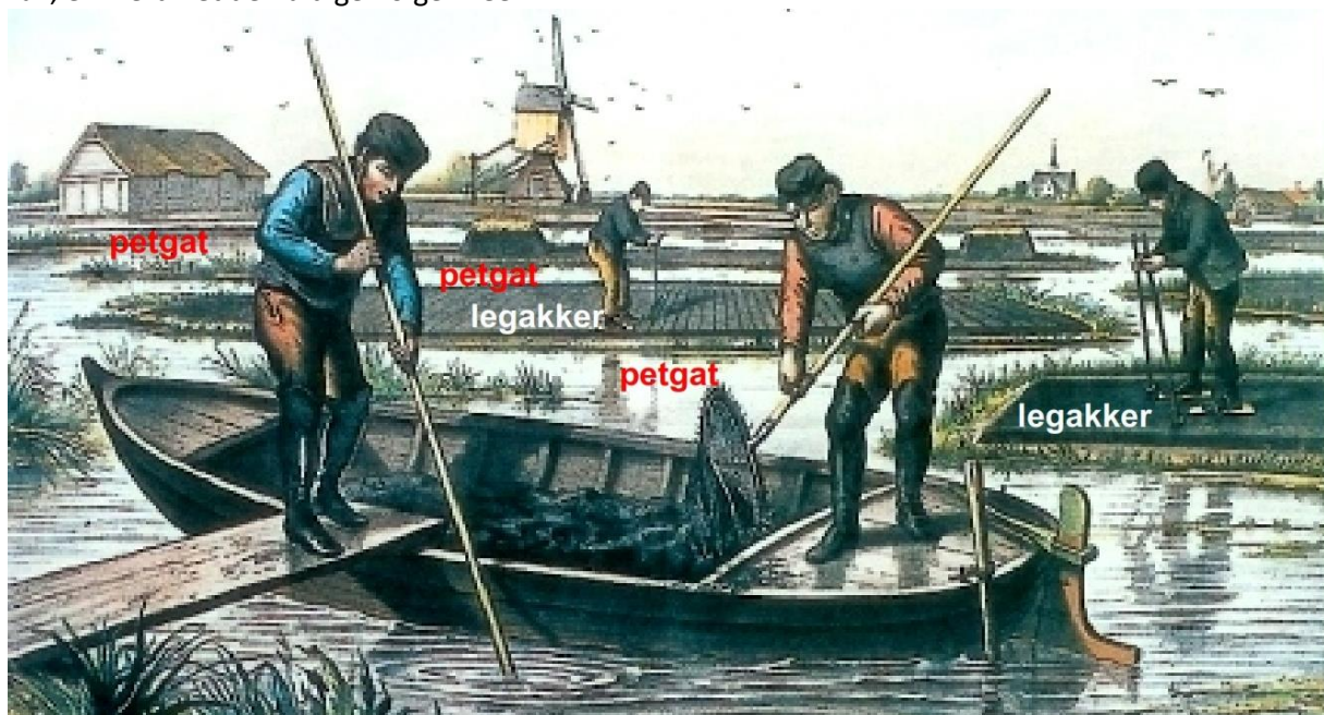
Figuur 39. Door het slagturven ontstonden smalle sloten (petgaten) en kleine eilandjes (legakkers) waarop vroeger de opgebaggerde turf te drogen werd gelegd. Het plaatje laat zich lezen als een stripverhaal: eerst wordt het rode veen onder water met een baggerbeugel opgebaggerd. Daarna wordt deze te drogen gelegd, platgestampt en in na het drogen in blokjes gesneden. Daarna wordt de turf opgestapeld op vierkante hopen (afgedekt met stro) en tenslotte in een schuur opgeborgen.
